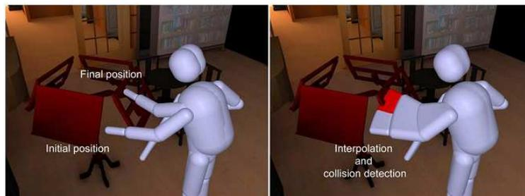
Figura 10 – Mecanismo de detecção de colisões com base em interpolação
