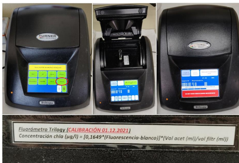
Figura 4.14 – Etapas da segunda fase do teste de calibração.
