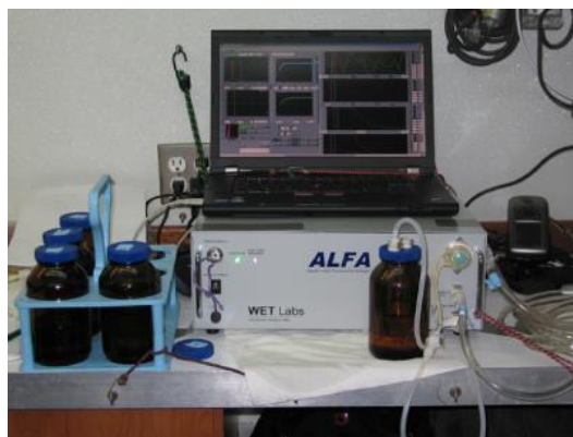
Figura 2.5 - Configuração do instrumento de medição ALFA [45].
