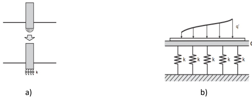
Figura 15 - Modelo de winkler aplicado em: a) fundação rasa + subleito; b) laje + subleito
