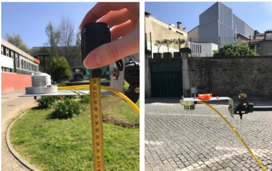
Figura 27 – Piranómetro devidamente posicionado e alinhado para medir a radiação solar emitida, à esquerda, e a radiação solar refletida, à direita
