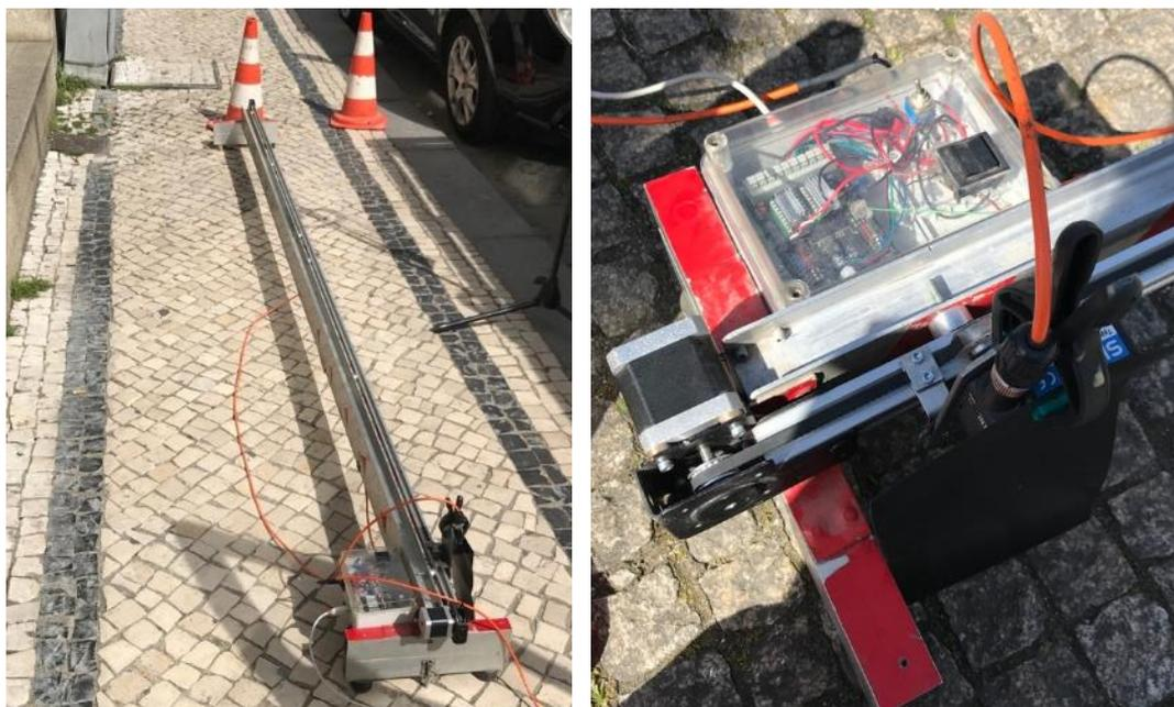
Figura 14 – Ensaio com a régua de 3 metros na calçada à Portuguesa em Braga (à esquerda) e laser com viseira de proteção do sol (à direita)
