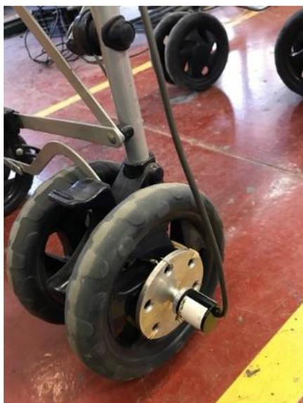
Figura 16 – *Encoder* rotativo colocado na roda do carrinho de bebé para medição da distância percorrida
