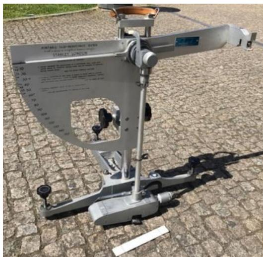
Figura 17 – Pêndulo Britânico utilizado para medir o atrito
