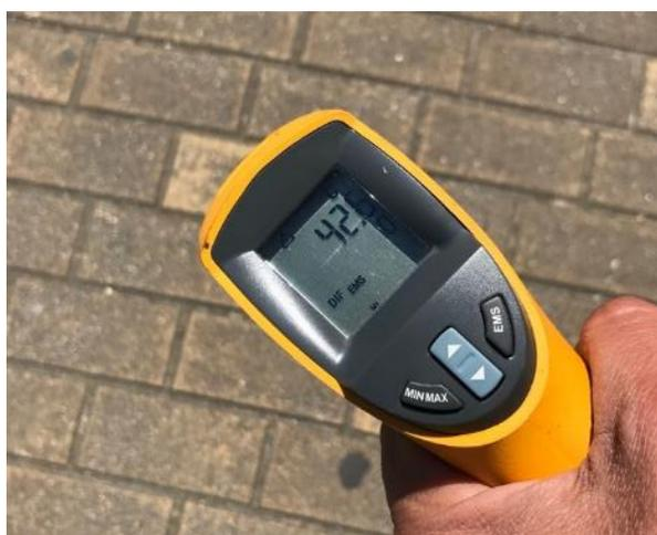
Figura 23 – Temperatura registada na superfície do passeio com blocos de betão com o termómetro de infravermelhos
