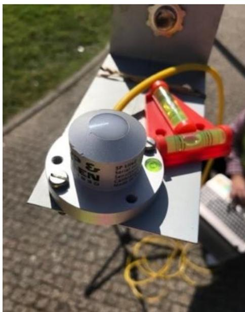
Figura 26 – Piranómetro devidamente montado no tripé para medição do albedo
