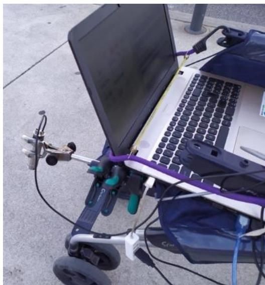
Figura 25 – Sensor infravermelho de temperatura colocado no carrinho de bebé para medição contínua da temperatura da superfície do pavimento
