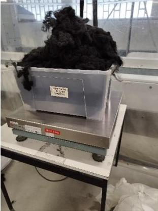
Figura 49-Pesagem da matéria fibrosa de resíduo e poliéster reciclado. Acervo próprio.
