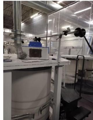
Figura 50-Processo de acumulação de fita e transporte para a fase de laminação. Acervo próprio.
