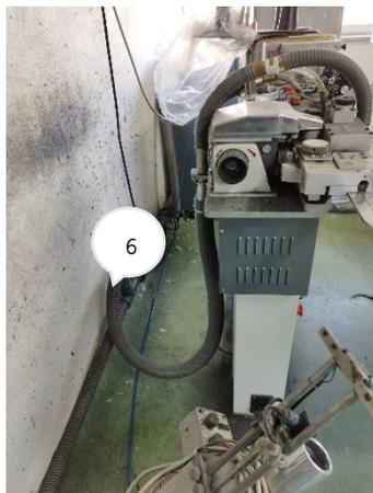
Figura 17-Tubagens para transporte de resíduos apenas da máquina de corte. Acervo próprio.
