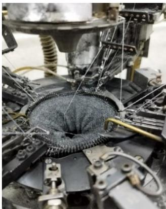
Figura 62-Visão interna do tear do processo de tricotagem da meia. Acervo próprio.
