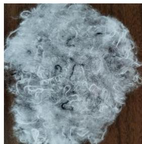
Figura 37-Resultado do 1º teste do processo de desfibrção das meias com duas passagens. Acervo próprio.
