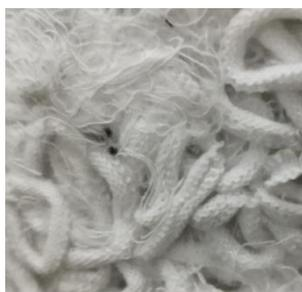
Figura 10-Resíduo de mistura de malha e filamento. Acervo próprio.
