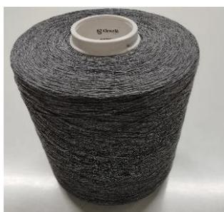
Figura 45-Fio de mistura de filamento e malha em formato de argola de 20 Ne. Acervo próprio.
