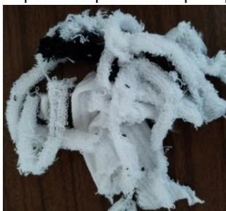
Figura 36-Resultado do processo de trituração das meias com duas passagens. Acervo próprio.
