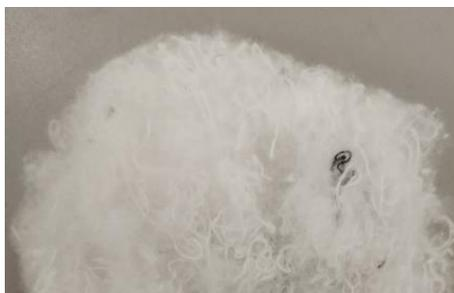
Figura 29-Fibras resultantes do 1º teste de reciclagem dos resíduos têxteis em formato de argola. Acervo próprio.
