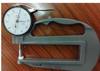
Figura 66-Micrómetro analítico da marca, Mitutoyo. Acervo próprio.
