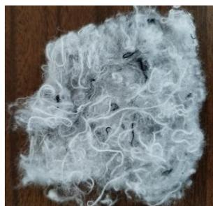
Figura 38-Resultado do 1º teste do processo de desfibrção das meias com uma passagem. Acervo próprio.
