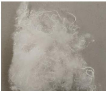
Figura 30-Fibras resultantes do 2º teste de reciclagem dos resíduos têxteis em formato de argola. Acervo próprio.
