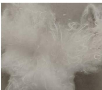
Figura 31-Fibras resultantes do 3º teste de reciclagem dos resíduos têxteis em formato de argola. Acervo próprio.
