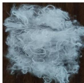
Figura 34-Resultado do processo de desfibrção dos resíduos em mistura com uma passagem. Acervo próprio.
