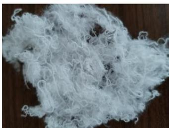
Figura 35-Desperdício originado pelo processo de desfibrção. Acervo próprio.
