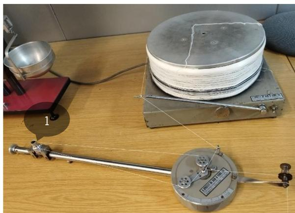
Figura 59-Medidor do coeficiente de atrito. Acervo próprio.
