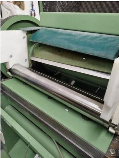
Figura 24-Cilindro com lâminas de corte da
