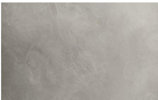
Figura 27-Fibras resultantes do 2º teste de reciclagem dos filamentos. Acervo próprio.
