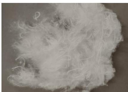
Figura 26-Fibras resultantes do 1º teste de reciclagem dos filamentos. Acervo próprio.
