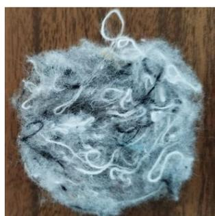
Figura 41-Resultado do 2º teste do processo de desfibrção das meias com uma passagem. Acervo próprio.
