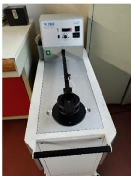
Figura 68-Aparelho de medição de permeabilidade ao ar, TEXTEST FX3300. Acervo próprio.
