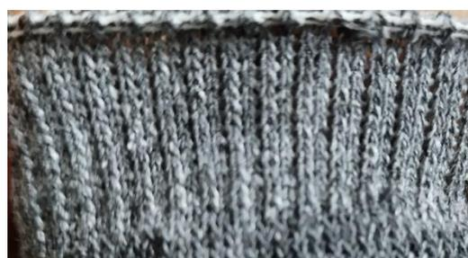
Figura 75-Malha com estrutura de falso rib. Acervo próprio.
