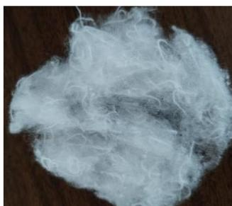
Figura 33-Resultado do processo de desfibrção dos resíduos em mistura com duas passagens. Acervo próprio.
