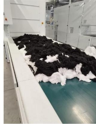
Figura 48-Mistura da matéria fibrosa para homogeneização da rama final. Acervo próprio.
