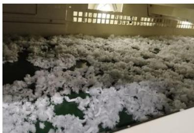
Figura 32-Desperdício do processo de desfibrção dos filamentos. Acervo próprio.
