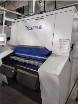
Figura 51-Processo de cardação da mecha para formação de fita. Acervo próprio.
