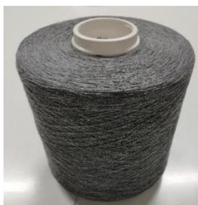
Figura 46-Fio de mistura de resíduo de filamento e malha em formato de argola de 15 Ne. Acervo próprio.
