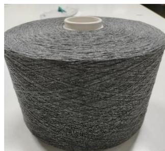
Figura 42-Fio de resíduo de filamento de 10 Ne. Acervo próprio.
