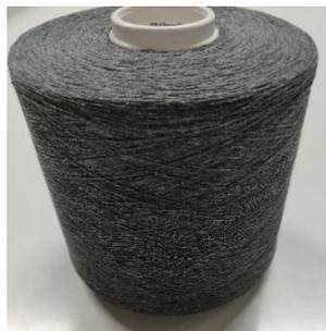
Figura 43-Fio de resíduo de mistura de filamento e malha em formato de argola de 10 Ne. Acervo próprio.
