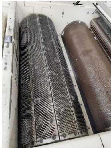
Figura 23-Cilindro desfibrador. Acervo
