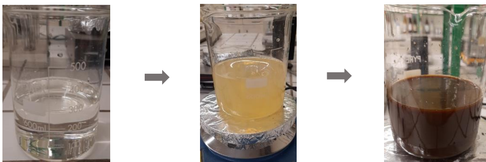
Figura 9. Processo de síntese das nanopartículas de prata Acervo próprio
