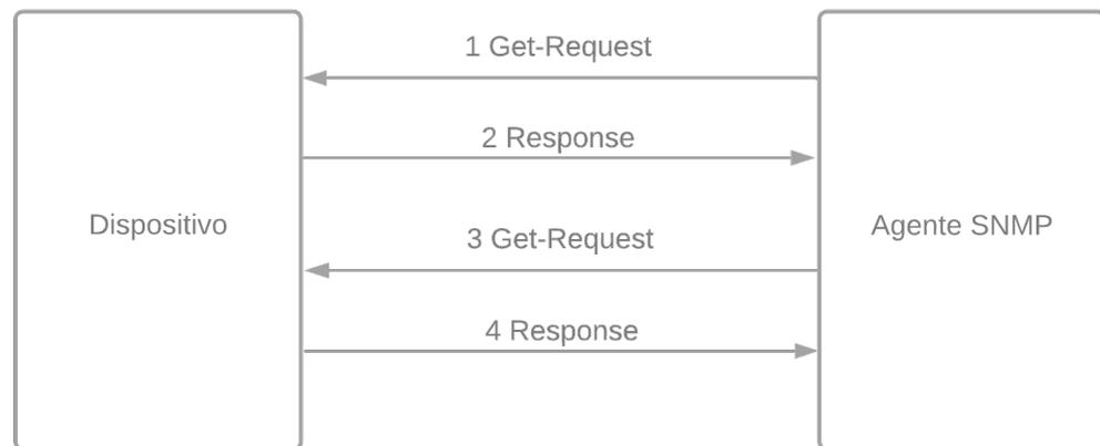
Figura 12: Comunicação entre Dispositivo e Agente SNMP para obtenção da última amostra lida por um sensor
