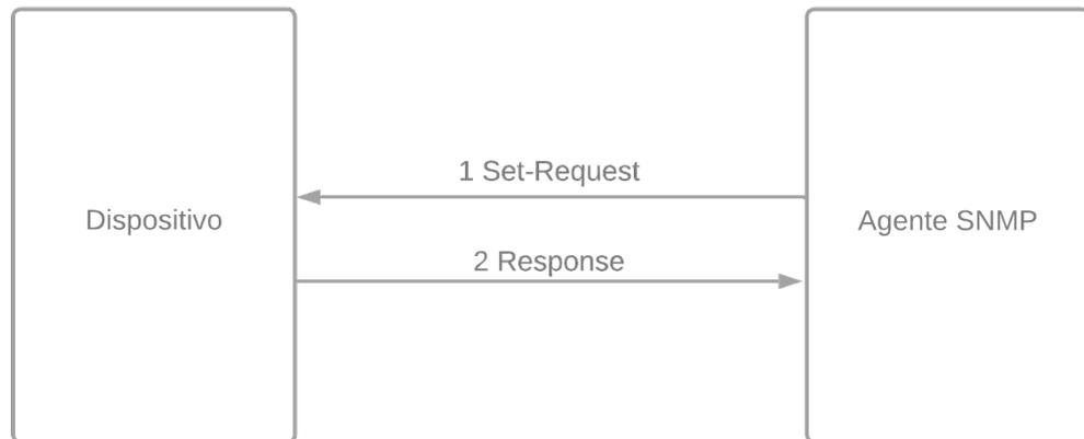
Figura 13: Comunicação entre Dispositivo e Agente SNMP de atuação num dispositivo
