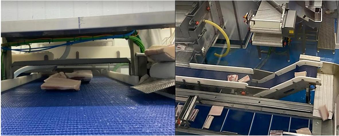
*Figura 32 - Vidragem no túnel criogénico*
