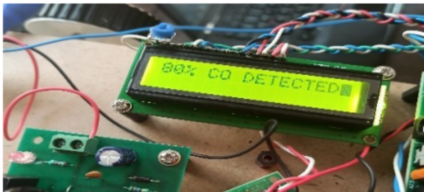
Figura 16: Indicação dos gases de escape [11]
