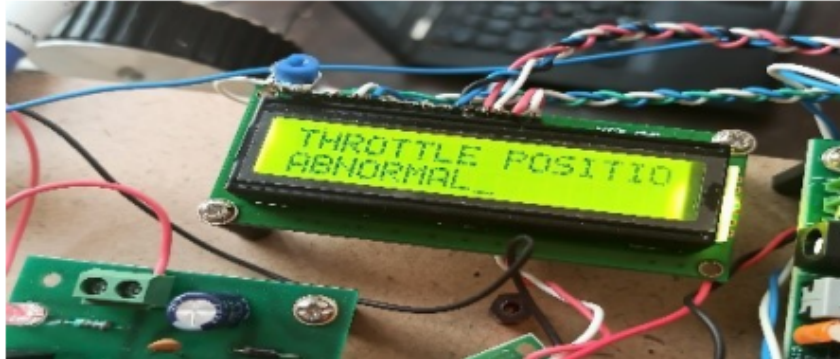
Figura 15: Indicação anormal da posição do acelerador [11]
