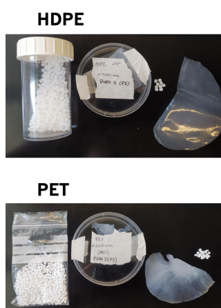
Figura 4.33: Amostras utilizadas para teste do sensor, onde o PET apresenta uma espessura de 50\mu\text{m} e o HDPE com uma espessura de 45\mu\text{m} .
