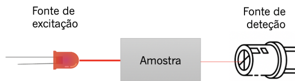
Figura 4.34: Modo de funcionamento do sensor desenvolvido.
