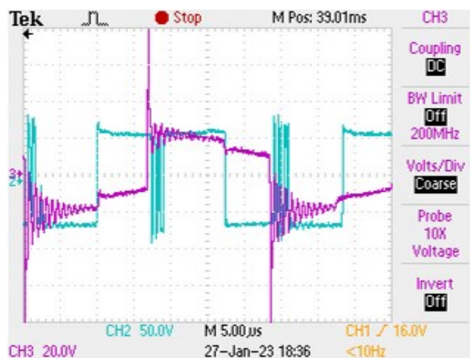
Figura 85: Resultado do desfasamento obtido com o algoritmo de MPPT de perturbação e observação. Tensões à saída do conversor CC-CA.
