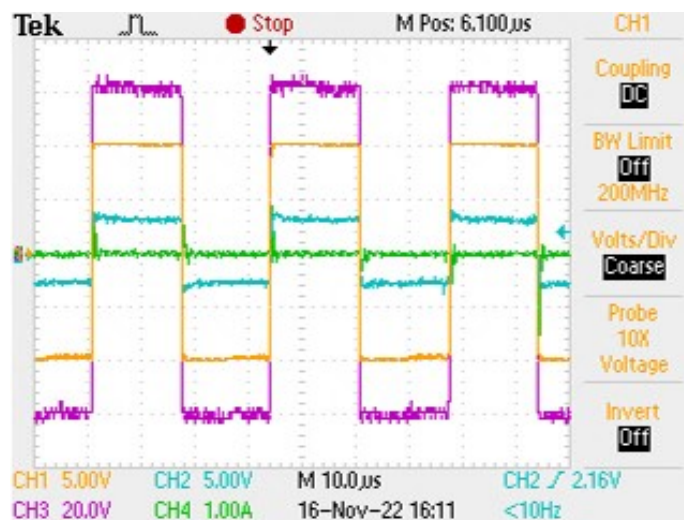
Figura 81: Resultado experimental no modo TAB sem desfasamentos. Tensões à saída do conversor CC-CA e corrente de entrada do enrolamento do painel solar.
