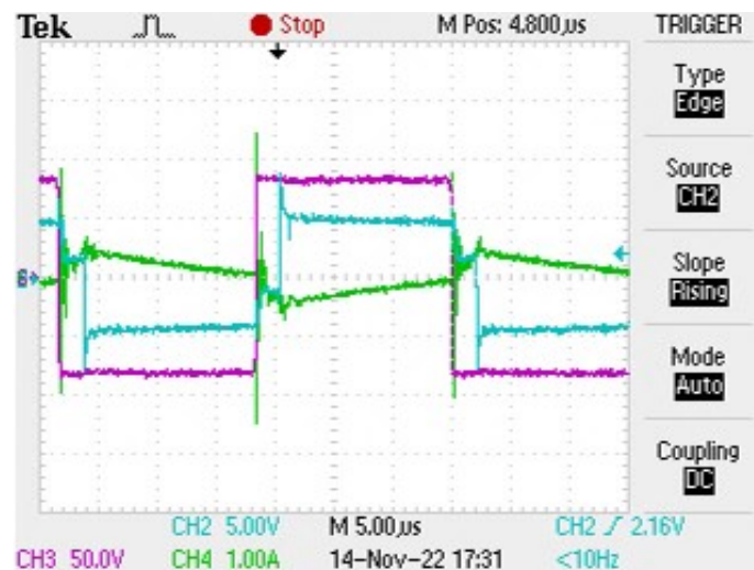
Figura 76: Resultado experimental ampliado no modo DAB entre a rede domestica e o sistema de armazenamento com desfasamento de 15°. Tensões à saída do conversor CC-CA e corrente de entrada do enrolamento do sistema de armazenamento.
