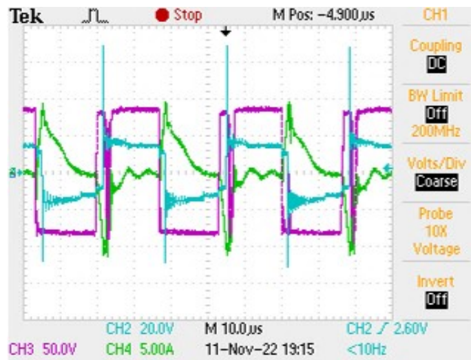
Figura 79: Resultado experimental no modo DAB entre a rede domestica e o com desfasamento de 15^\circ . Tensões à saída do conversor CC-CA e corrente de entrada do enrolamento do painel solar.
