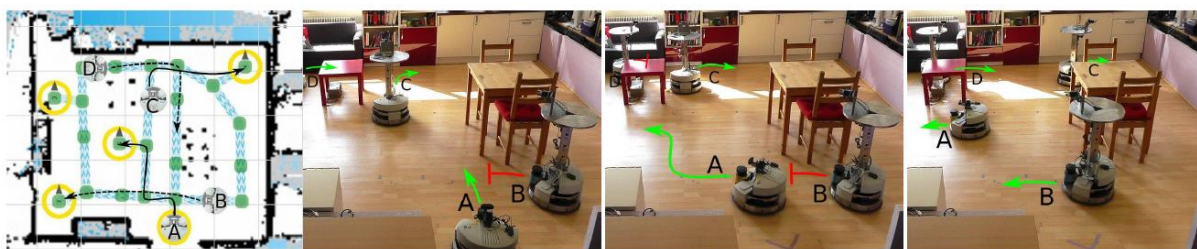
Figura 2-14 - Ambiente real com uma frota de quatro robôs e navegação coordenada num espaço pequeno e denso. A imagem da esquerda mostra o layout da rede de caminhos e as rotas que cada robô vão seguir. Retirado de (Lutz et al., 2016)
