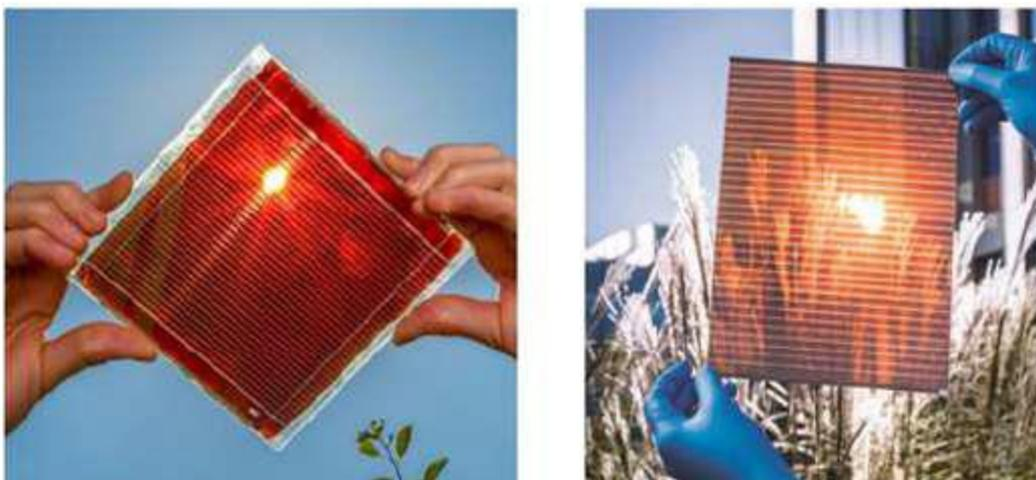
Figura 22- Exemplo de célula fotovoltaica de Perovskita, (CRESESB, CEPEL, 2014)
