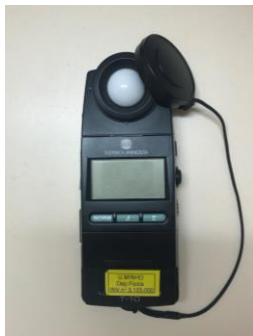
Figura 10 – Iluminânciômetro Konica Minolta T-10. Figura 11 – Luminânciômetro Konica Minolta LS-110.
