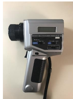
Figura 10 – Iluminânciômetro Konica Minolta T-10. Figura 11 – Luminânciômetro Konica Minolta LS-110.
