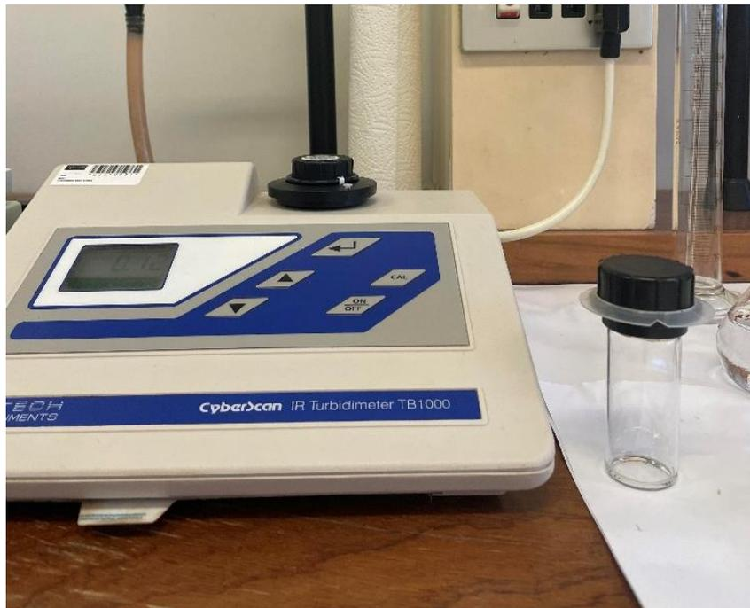
**Figura 34.** Turbidímetro utilizado na quantificação dos sulfatos presentes nas amostras.
