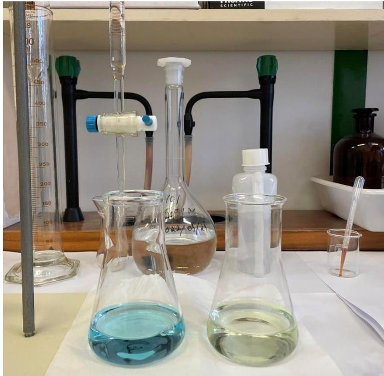
**Figura 33.** Titulação para a determinação da alcalinidade total.
