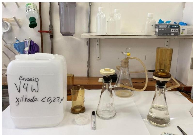
**Figura 31.** Filtração em vácuo da amostra V4w.
