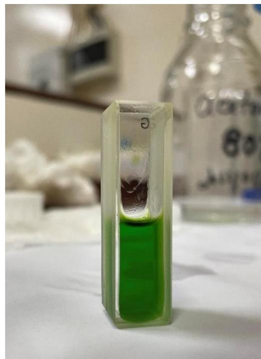
**Figura 34.** Amostra de clorofila para leitura no espectrofotômetro.
