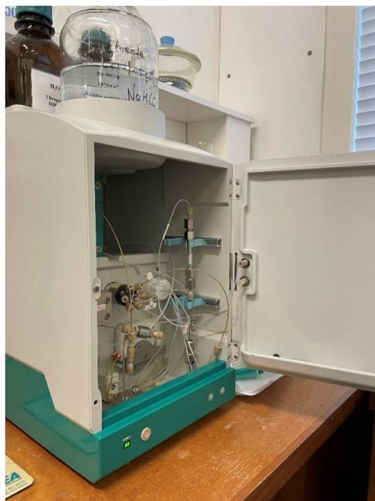
**Figura 35.** Equipamento utilizado para análise de sulfatos por cromatografia iónica com suspensão química.
