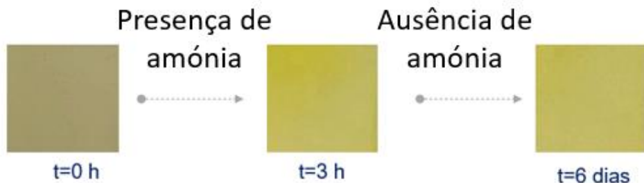
Figura 34: Mudança de cor dos revestimentos funcionais na ausência de amónia.
