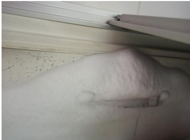
Figura 14 Arca de congelados, com grande acumulação de gelo.
