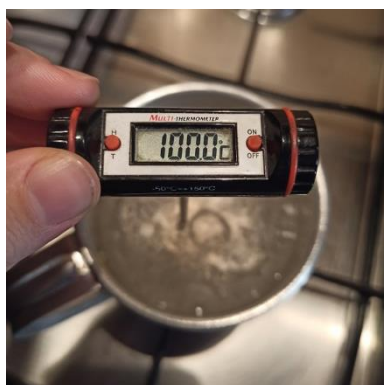
Figura 13 Termómetro colocado em água a ferver, apresentando o valor de 100,0^{\circ}\text{C}
