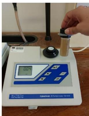
Figura 4.12 - Turbidímetro TB1000.
