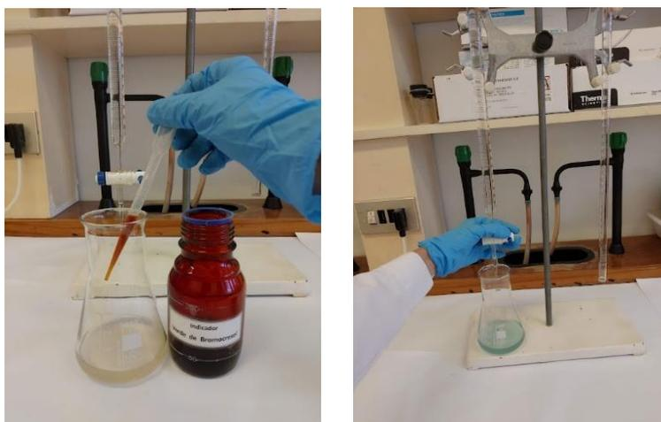
Figura 4.8 - Procedimentos realizados para a análise da alcalinidade.
