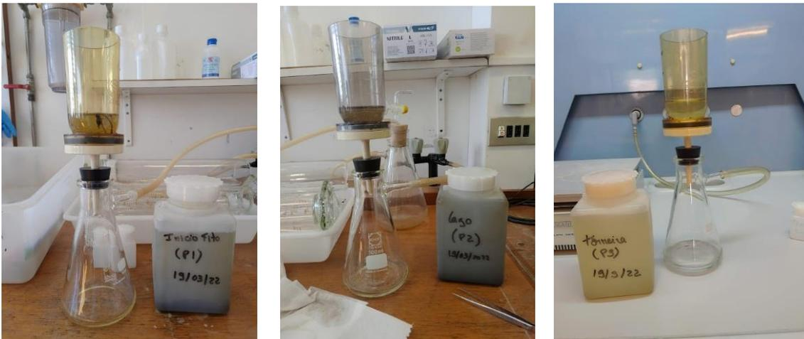
Figura 4.6 - Impasse na filtração devido às partículas retidas nas membranas.
