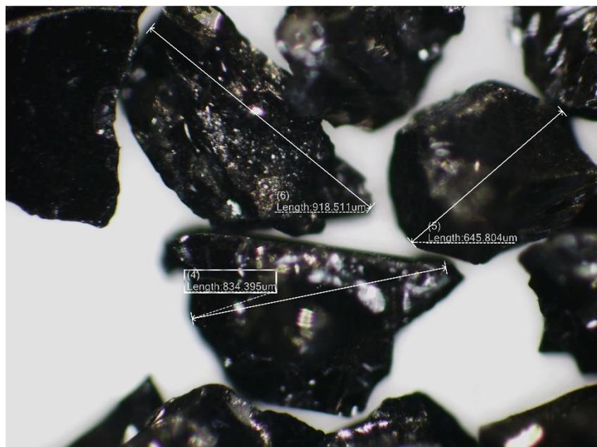
**Figura 24:** Grãos abrasivos com o respetivo comprimento em  $\mu\text{m}$ .
