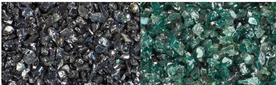
**Figura 5:** Grãos de carboneto de silício pretos (esquerda) e verdes (direita). [17]
