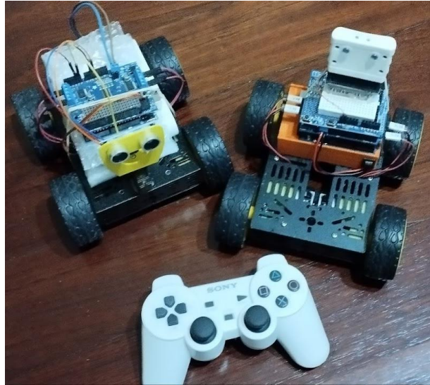
Figura 49 – Robot que evita obstáculos e robot controlado por um comando da Playstation 2
