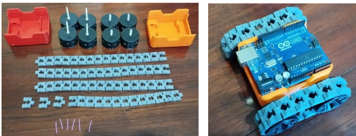
Figura 53 – Robot modular impresso em 3D
