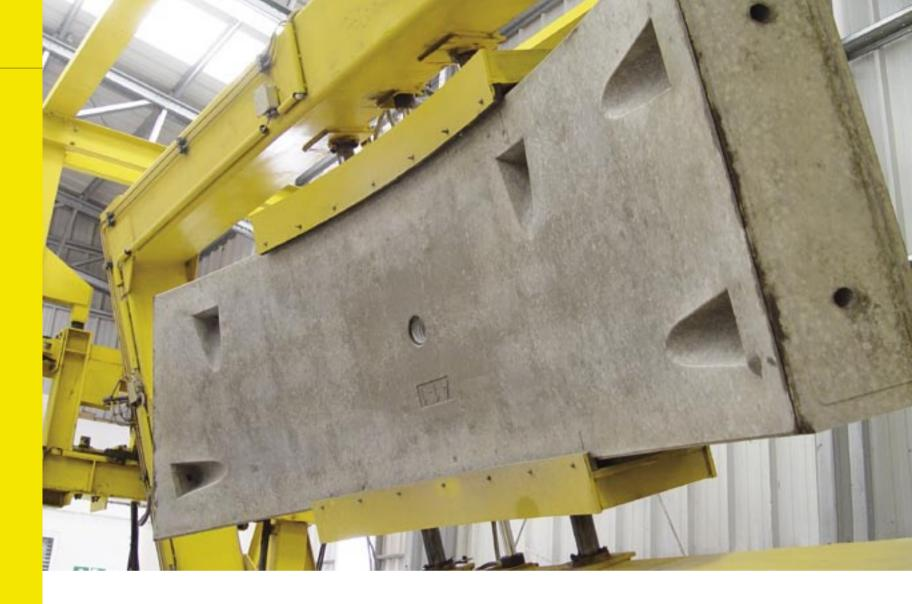
da superfície das aduelas. Neste sentido, uma armadura em malha convencional ficará exposta ao meio ambiente, o que levará a um início precoce do processo de corrosão da armadura. É clara, assim, a vantagem da utilização das fibras de aço: estas estarão presentes em todo o volume do betão, resultando num aumento da resistência ao impacto. Em consequência, a opção por um reforço constituído por fibras de aço pode reduzir o número de aduelas danificadas.
