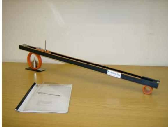
**Figura A7 – *Maillemètre* - Medidor de comprimento de laçada**
