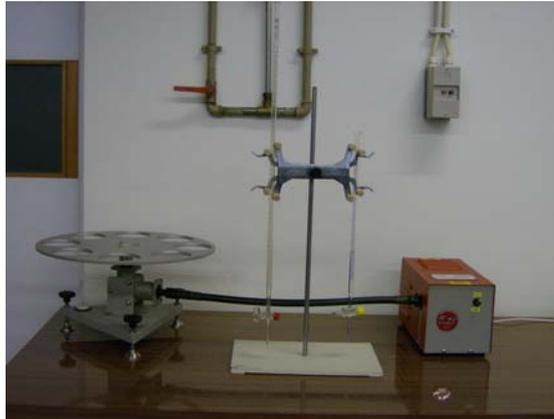
**Figura A3 – Aparelho permeabilímetro ao vapor de água**
