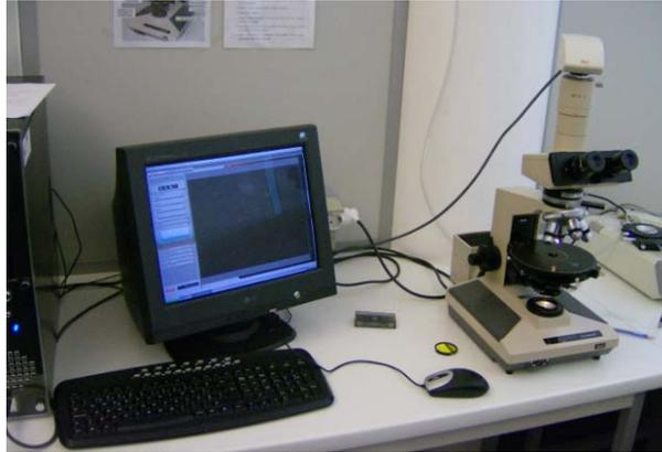
**Figura A9 – Microscópio de Transmissão Olympus BH com sistema de imagem Leica Quantiment 500**
