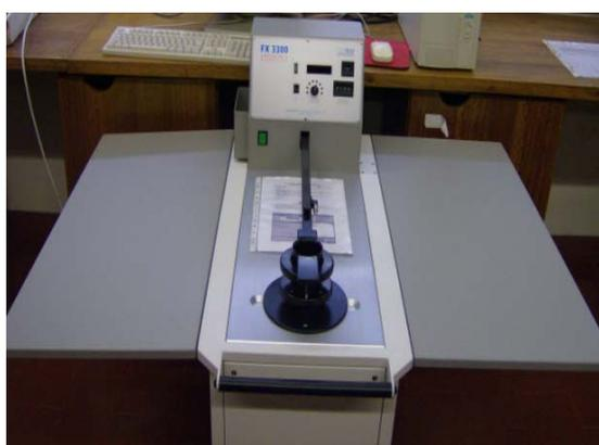
**Figura A2 – Aparelho permeabilímetro ao ar**
