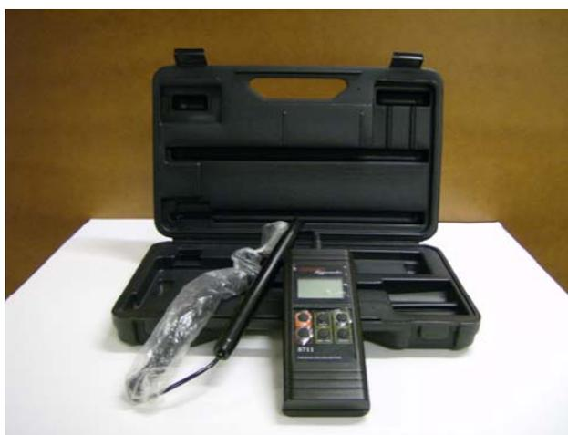
**Figura A12 – *Thermo-higrometer* modelo 8711**
