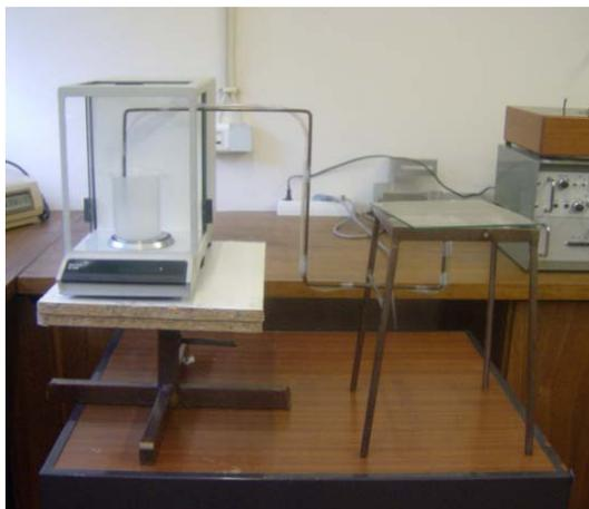
**Figura A5 – Aparelho Capilaridade horizontal**
