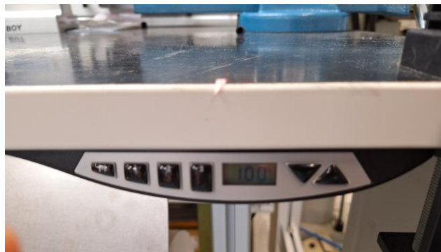
Figura 70 - Sistema de controlo de altura da bancada de montagem.
