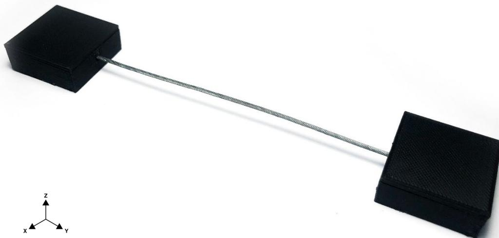
Figura 36 – Cabo de aço embebido em dois pontos de ancoragem.
