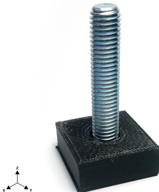
Figura 31 - Acabamento superficial da peça teste com Parafuso M10 embecido numa posição vertical (eixo Z).
