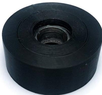
Figura 34 – Peça teste com rolamento embebido.
