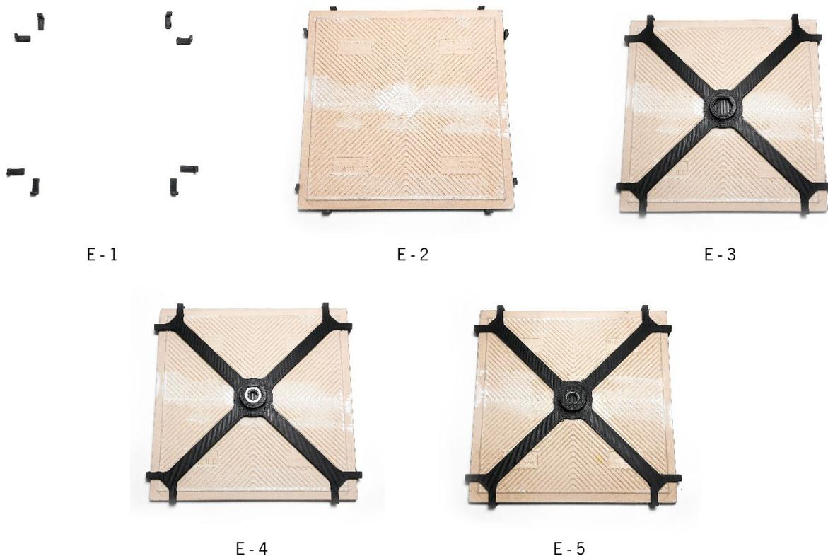
Figura 58 – Etapas do processo de fabrico dos módulos teste 1 e 2.
