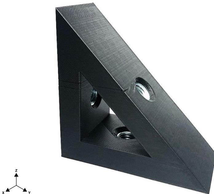
Figura 13 - Peça com três porcas embebidas através da combinação de orientações.
