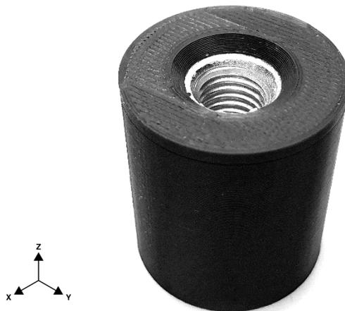
Figura 14 - Porca de união sextava M10 embebida na orientação vertical (eixo Z).
