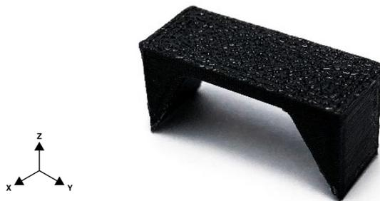
Figura 25 - Estrutura de atravancamento interna utilizada para embeber uma porca sextavada na orientação horizontal (eixo X).
