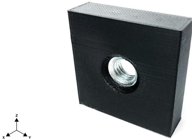
Figura 26 – Peça teste com porca sextava M10 embebida na orientação horizontal (eixo X).
