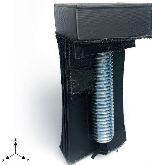
Figura 30 - Peça teste com Parafuso M10 embecido numa posição vertical (eixo Z).
