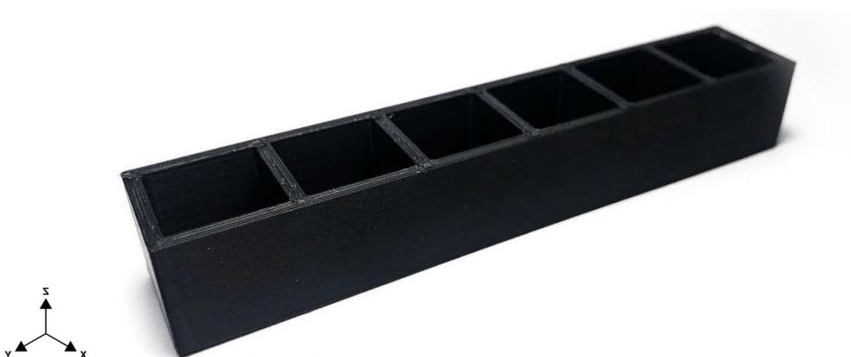
Figura 5 - Peça teste de compensação dimensional nos eixos X e Y.
