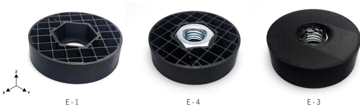
Figura 8 - Sequência do processo de embeber uma porca sextavada na orientação vertical (eixo Z).
