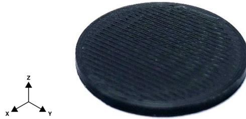
Figura 18 - Estrutura interna para revestir a cabeça do parafuso sextavado M10.
