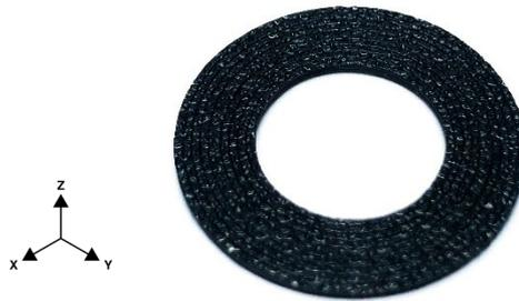
Figura 33 – Estrutura interna utilizada para embeber o rolamento.
