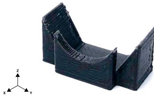
Figura 15 - Estrutura de atravancamento interna para embeber um parafuso de cabeça sextavada M10 na orientação horizontal (eixo X).
