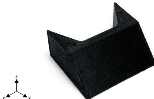
Figura 27 – Estrutura de atravancamento interna utilizada para embeber uma porca sextavada na orientação oblíqua (ângulo de 45°).
