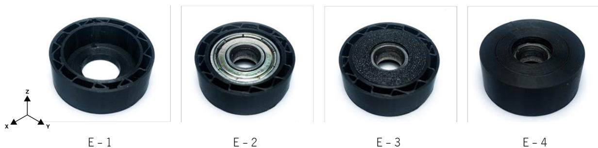
Figura 20 - Sequência do processo de embeber um rolamento na orientação vertical (eixo Z).
