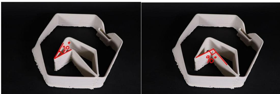
Figura 40: Teste de Ângulos Interiores
