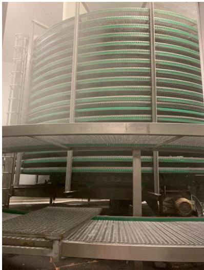
Figura 16 - Túnel de congelação em espiral
