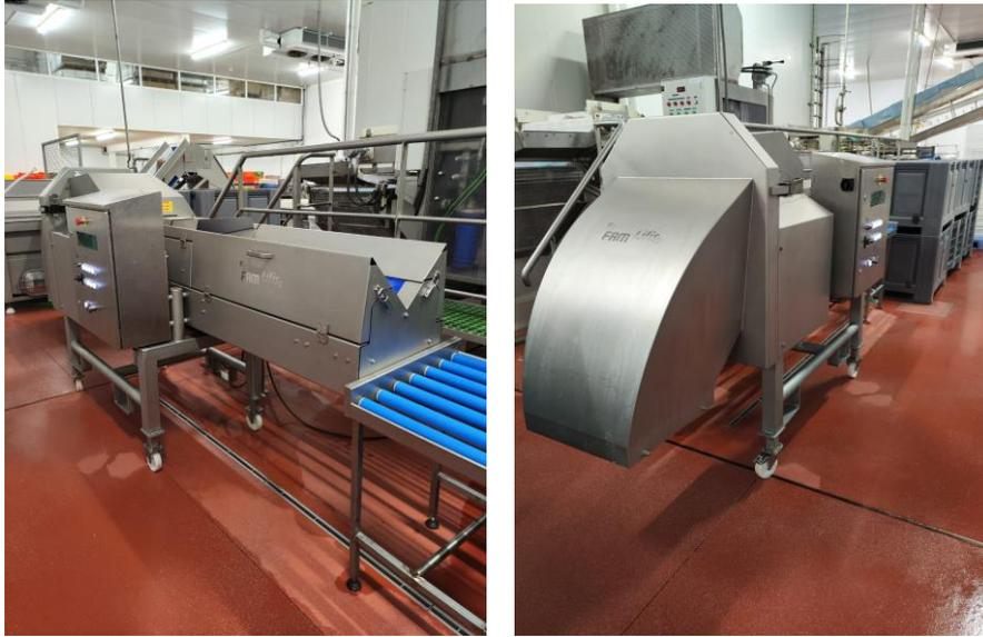
Figura 22 - Máquina de corte de manto de pota em tiras ou cubos de pota
