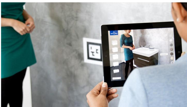
Figura 5: Exemplo de utilização de AR baseada em marcadores
