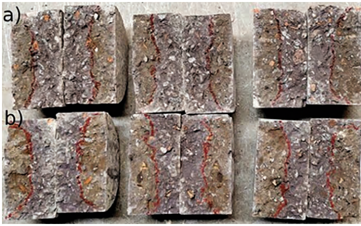
Figura 8: Profundidade de penetração de cloretos: a) betão com incorporação de 25% de RCD; b) betão com incorporação de 25% de RCD funcionalizado com PCM.
