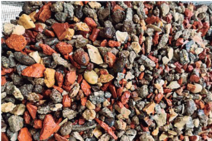
Figura 2: RCD funcionalizado com PCM.
