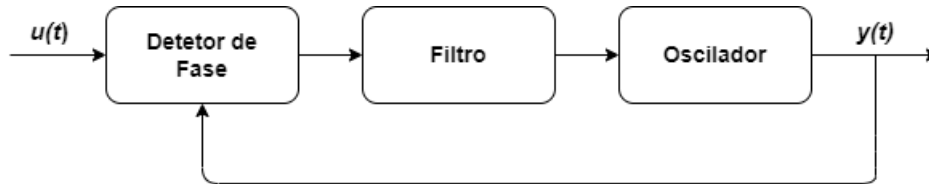
Figura 3.12 – Diagrama de blocos da PLL básica.
