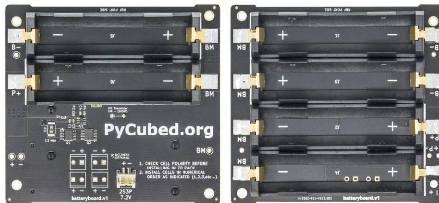
Figura 2.22 - Pcb da placa da bateria PyCubed [49].
