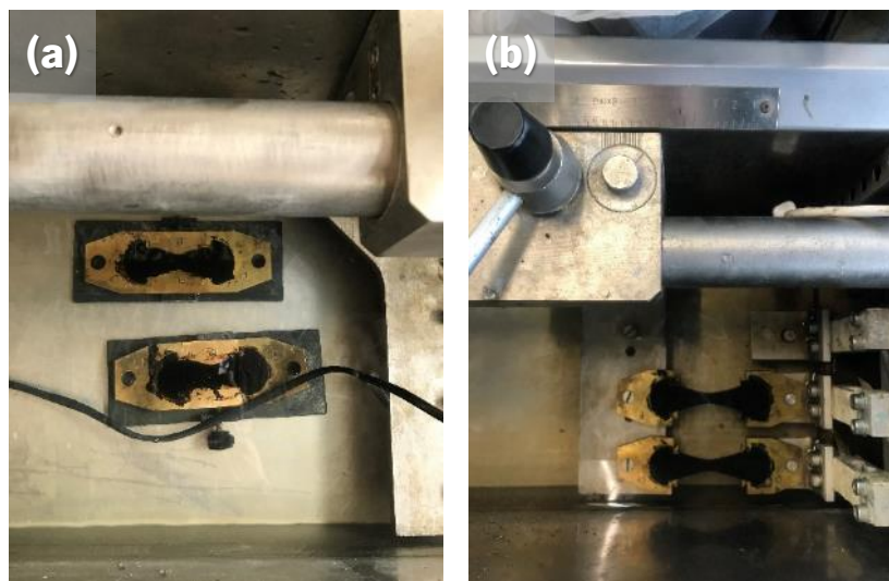
Figura 22 - Recuperação elástica: (a) Amostras em banho-maria; (b) Posição inicial de ensaio no ductilómetro
