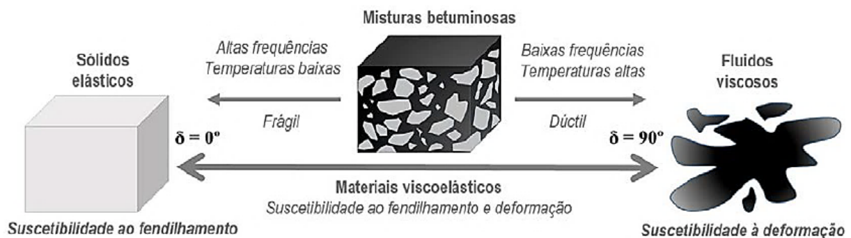
Figura 4 - Esquema da resposta viscoelástica da mistura betuminosa com a variação da temperatura (adaptado de Moreno-Navarro e Rubio-Gámez, 2016)
