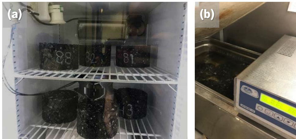
Figura 35 - Condicionamento dos provetes: (a) Provetes à temperatura ambiente; (b) Provetes em banho-maria
