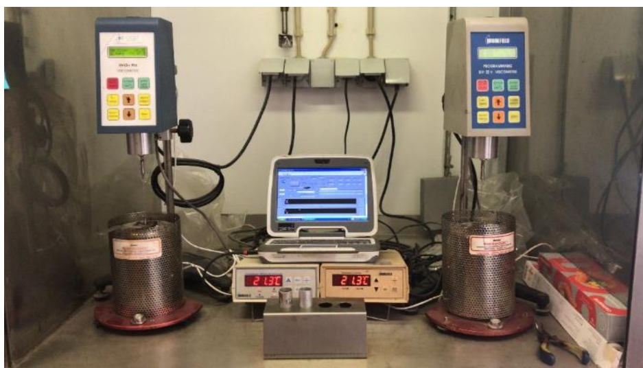
Figura 8 - Equipamento utilizado para a realização do ensaio de viscosidade dinâmica
