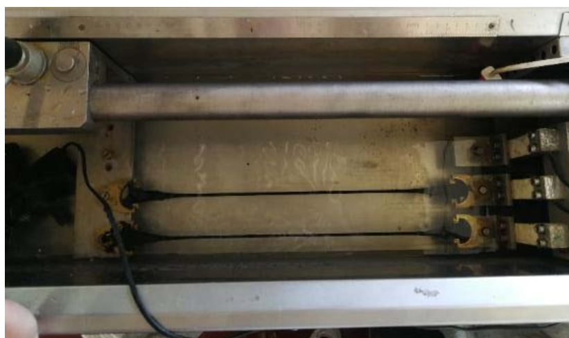
Figura 24 - Amostras em extensão máxima no ensaio de ductilidade
