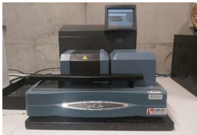
Figura 11 - Equipamento utilizado para realização do ensaio TGA
