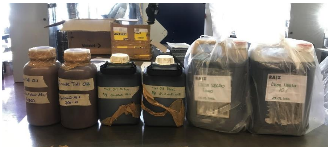
Figura 6 - Bio-óleo utilizados no trabalho (da esquerda para a direita): CTO ( crude tall oil ), TOP ( tall oil pitch ), LNF e LN70
