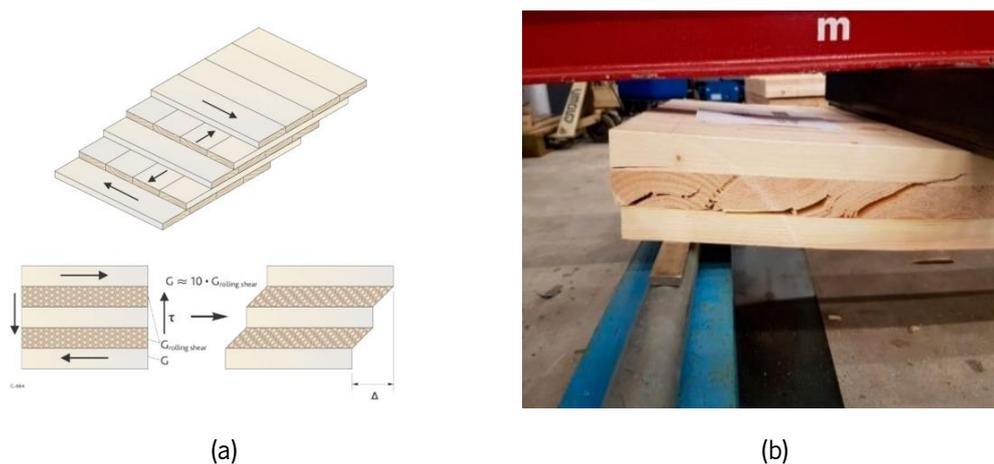
Figura 2.3 - Fenómeno de *rolling shear* num painel de MLC. (a) Desenho esquemático (Karacabeyli e Gagnon, 2019). (b) Ensaio experimental (O'Ceallaigh et al., 2018)
