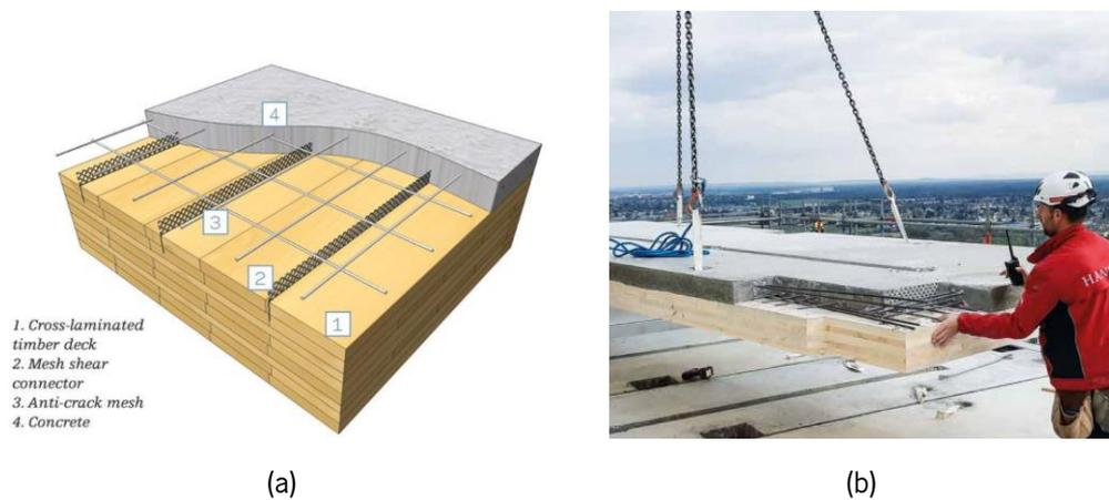
Figura 2.4 - Lajes mistas MLC-betão. (a) Composição de uma laje mista (Lane, 2012). (b) Aplicação de uma laje mista pré-fabricada (MMK, 2022).
