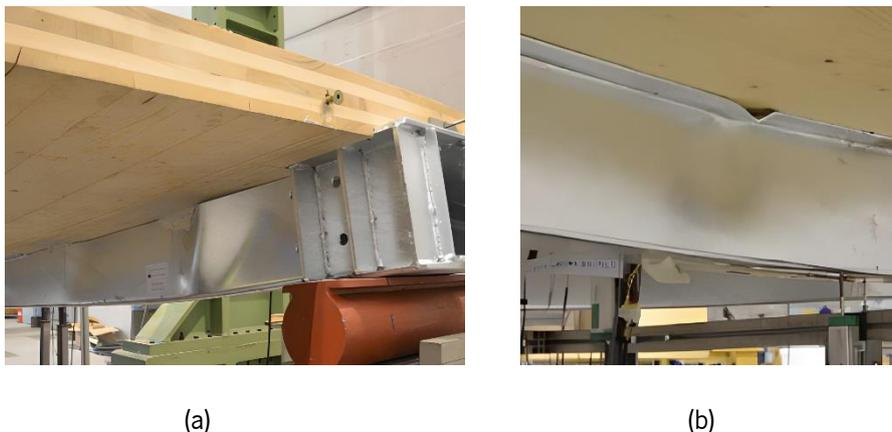
Figura 3.16 – Fenómenos de instabilidade de uma viga de aço enformado a frio constituinte de um sistema de laje composta MLC-viga de aço. (a) Encurvadura da alma da viga por solicitação ao corte (Owolabi e Loss, 2022). (b) Encurvadura local no banzo da viga (Loss e Davison, 2017).
