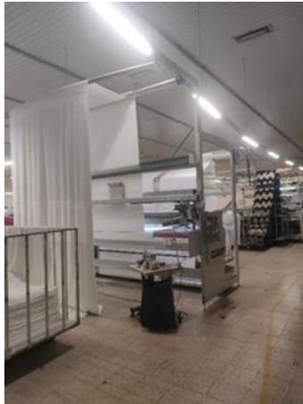
*Figura 25- Máquina de corte longitudinal.*
