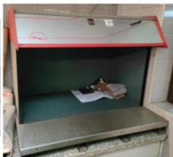
Figura 2- Cabine de luz de inspeção de cores têxteis.
