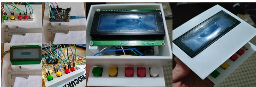
Figura 46- Da montagem dos componentes eletrónicos à união com estrutura de proteção externa.
