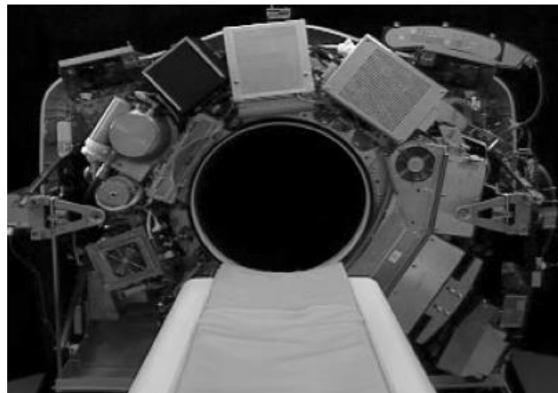
Figura 15 - Imagem de uma gantry de um equipamento de terceira geração (Adaptado de [53]).
