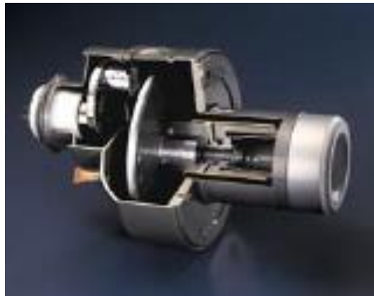
Figura 13 - Imagem de um tubo de raios-X moderno com ânodo rotativo (Adaptado de [6]).
