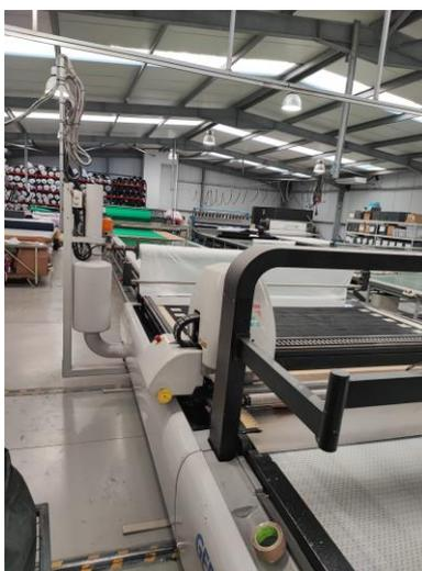
Figura 38 - Mesa de puxada de corte automática
