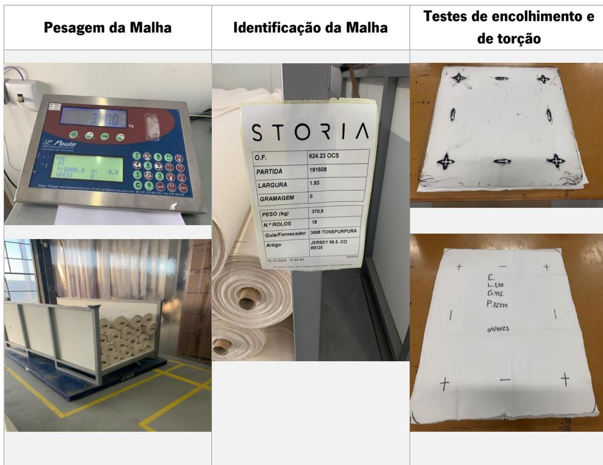
Figura 23 - Pesagem, identificação e testes de encolhimento e de torção de malha
