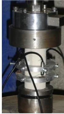
**Figura 8 – Esquema do ensaio para determinação do módulo de elasticidade da argamassa**
