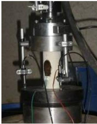
**Figura 6 – Determinação do módulo de elasticidade usando extensômetros e lvdts**
