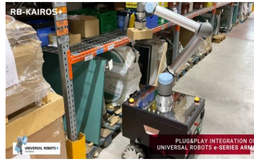
(b) Manipulação de um objeto pelo manipulador móvel RB-KAIROS+
