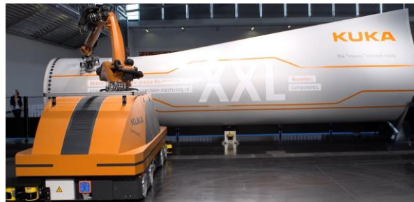
(c) Processo de polimento realizado pelo manipulador móvel KUKA KMR QUANTEC
