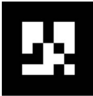
Figura 15: Marcador AprilTag utilizado como recurso à computação da posição 3D e orientação do veículo no espaço. Retirado de Fan Guangrui & Wang Geng (2017).
