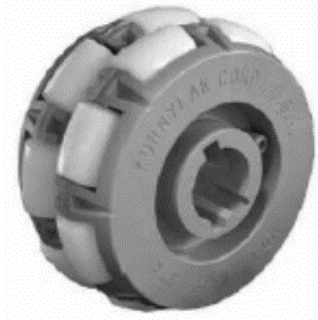
Figura 31: Roda do tipo Universal. Retirado de Jahanian & Karimi (2006).
