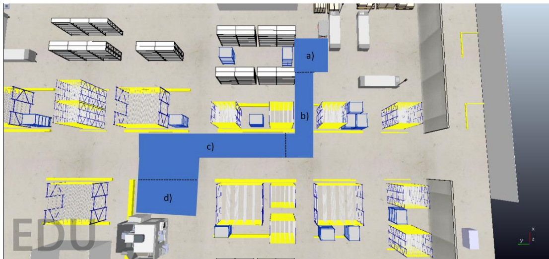
Figura 109: Representação da gestão de comportamentos que definem a ação de navegação e acostagem na zona de alimentação da máquina ferramenta. a) return from dock , b) navigation omnidirectional , c) navigation , d) go to dock .
