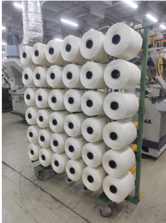
Figura 22 – Carros de esquinadeira para bobines de cabo.
