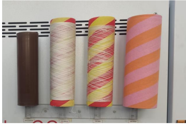
Figura 21 – Mostruário dos tubos do torcedor.
