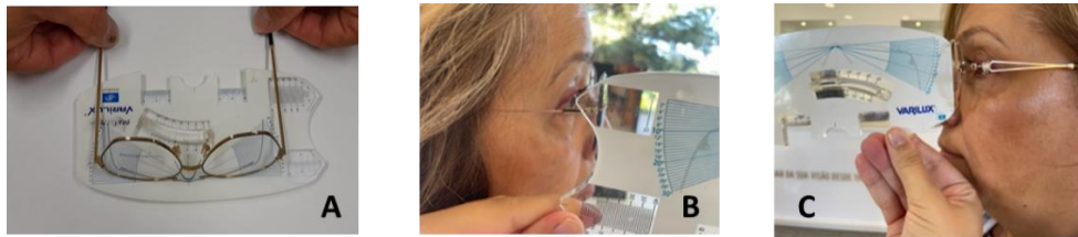
Figura 4-2 Exemplo da tomada de medida manual com régua Essilor: curvatura da armação (A); distância vértex (B) e ângulo pantoscópico (C)
