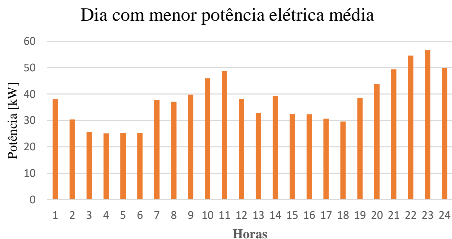
Figura 52 - Perfil horário de potência elétrica em utilização no dia com menor consumo.
