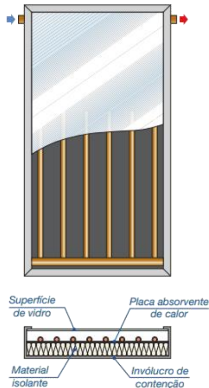
Figura 10 – Painel solar de líquido com proteção. [16] (adaptado)
