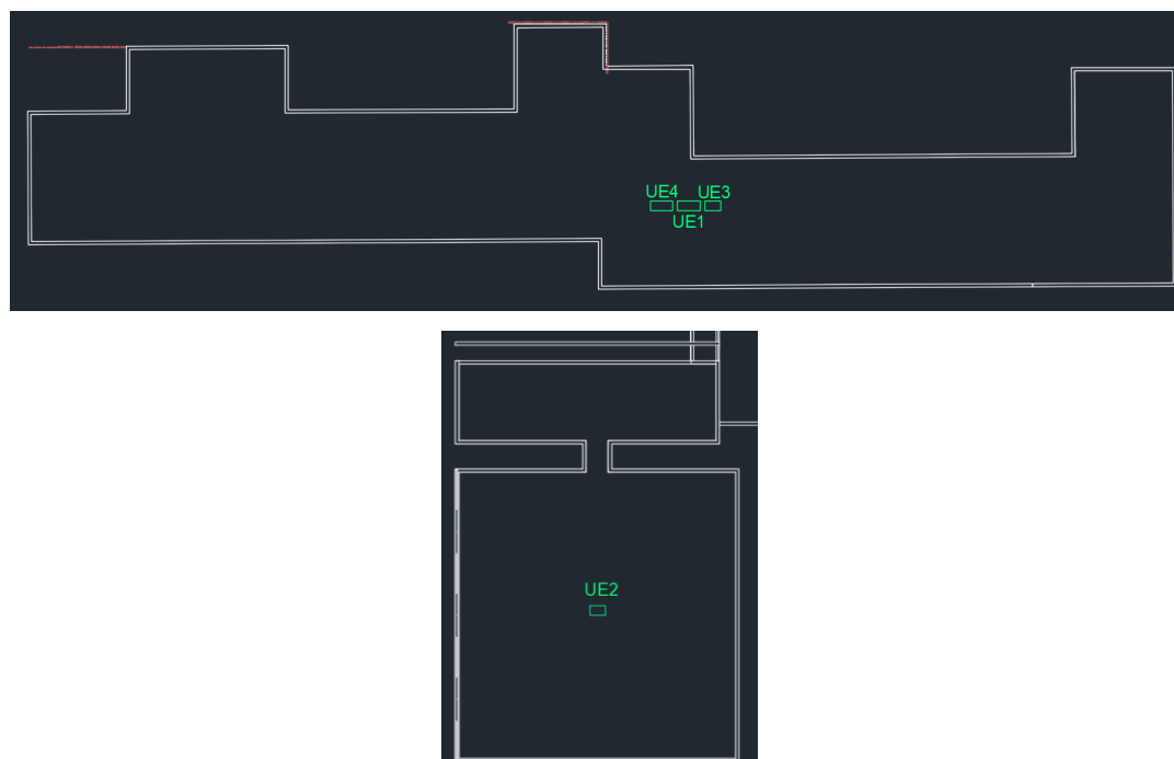
Figura 43 – Localização dos equipamentos de climatização nas coberturas da fase 1 e fase 2, representados a verde.
