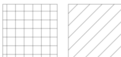
Figura 17 - Marcação de pavimentos e coberturas, respetivamente. [8]
