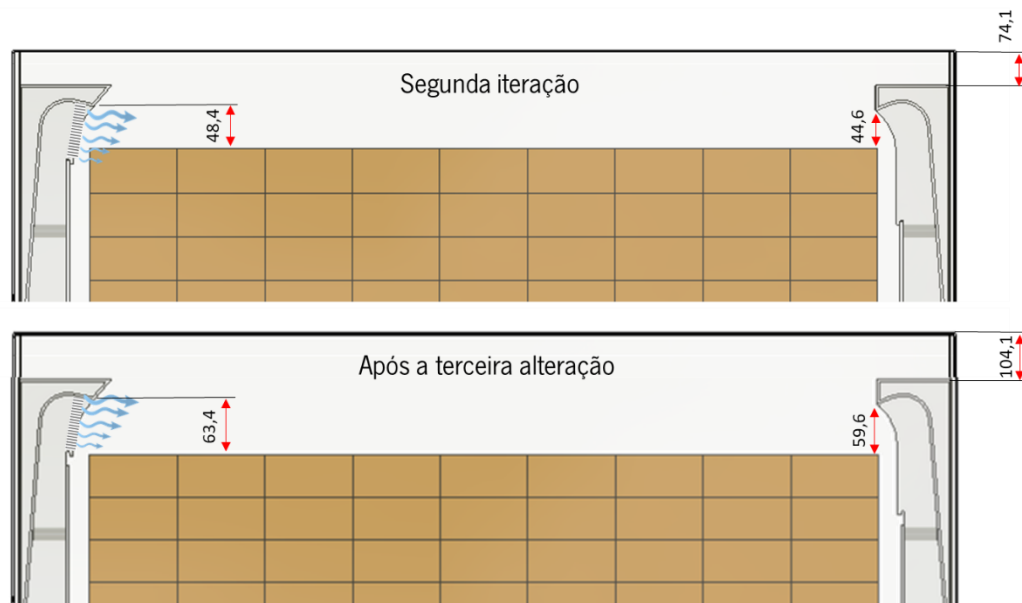
Figura 5.13 – Representação esquemática da subida das condutas de insuflação e aspiração e do incremento à altura dos vidros, comparativamente ao posicionamento destes na segunda iteração (dimensões em mm).
