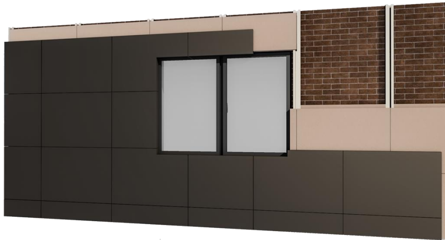
Figura 1 Integração da solução ZeroSkin+ na fachada do edifício. Os módulos são pré-fabricados com recurso à manufatura aditiva usando plástico reciclado como matéria-prima.
