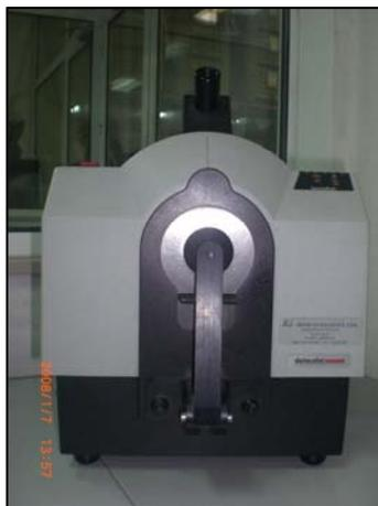
Figura 53: Espectrofotómetro de Reflexão.
