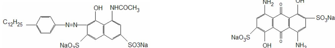
Figura 44: Corante C.I. Vermelho Ácido 138 (esquerda) e Corante C.I. Azul Ácido 45 (direita) (adaptado de Perkins, 1996).
