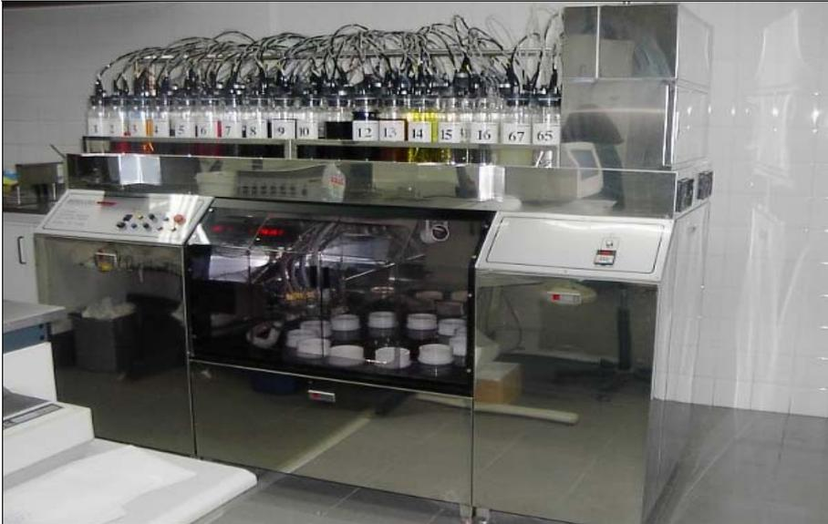
Figura 52: representação do equipamento de doseio de soluções de tingimento automático.
