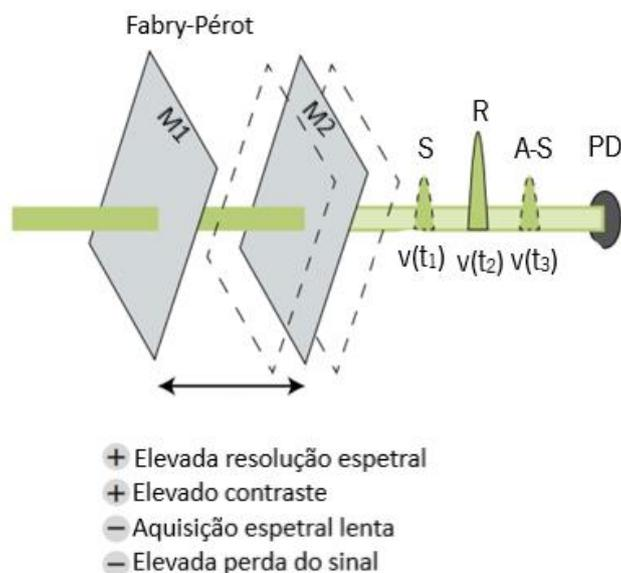
**Figura 2.15:** Esquema simples, vantagens e desvantagens de um *Tandem* Fabry-Pérot (adaptado de [13]).
