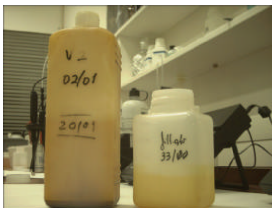
Figura 2.11- Exemplo da deposição de películas ocre nos frascos de reserva das amostras de efluente de Valdarças. Esta ferruginização observa-se logo nas primeiras semanas de armazenamento com refrigeração, mesmo em amostras filtradas.
