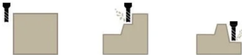
Figura 2.4. Manufatura subtrativa. Adaptado de [33].
