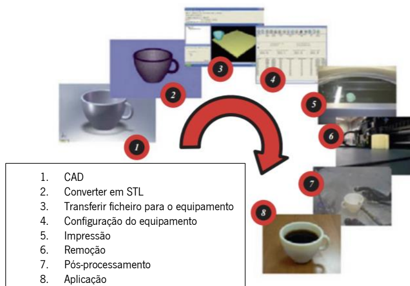
Figura 2.6. Fases do processo de MA [39].
