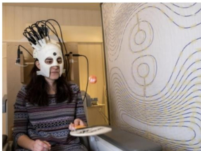
Figura 1.5. Equipamento de MEG baseado em OPMs. Adaptado de [15].
