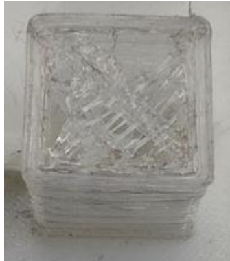
Figura 4.2. Falhas na face superior da célula.
