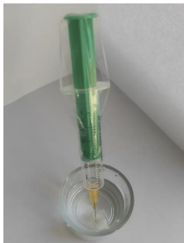
Figura 4.27. Execução de um teste de estanquicidade.
