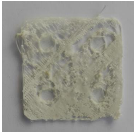
Figura 4.7. Exemplo de uma impressão falhada com TPU.
