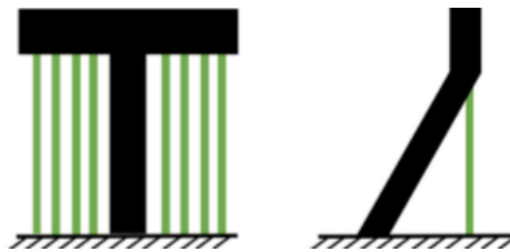
Figura 2.16. Suportes tipicamente utilizados no processo de fabrico por FDM. Adaptado de [96].
