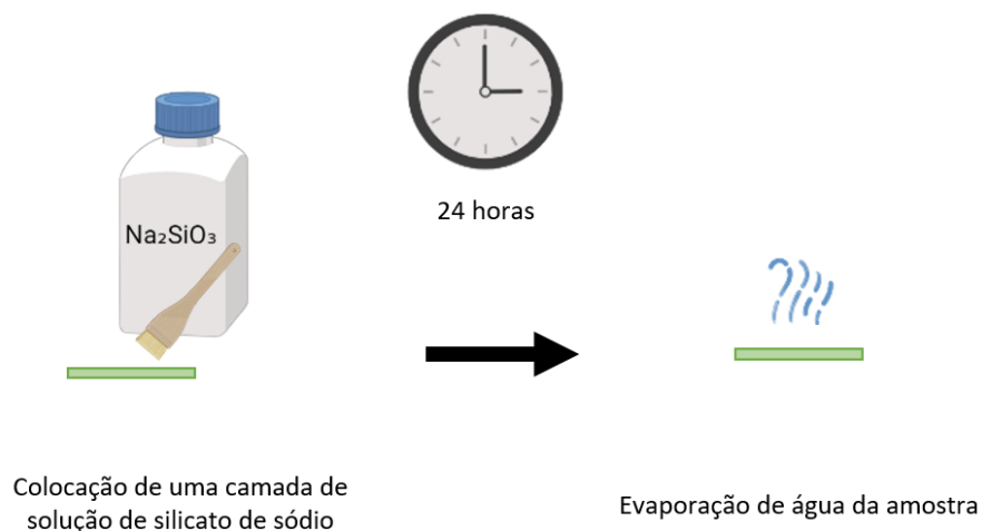
Figura 3.10. Processo de aplicação do silicato de sódio às amostras.
