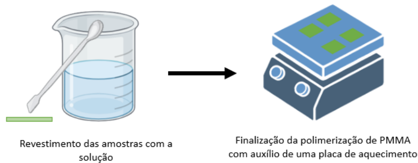
Figura 3.14. Método de aplicação do PMMA às amostras.
