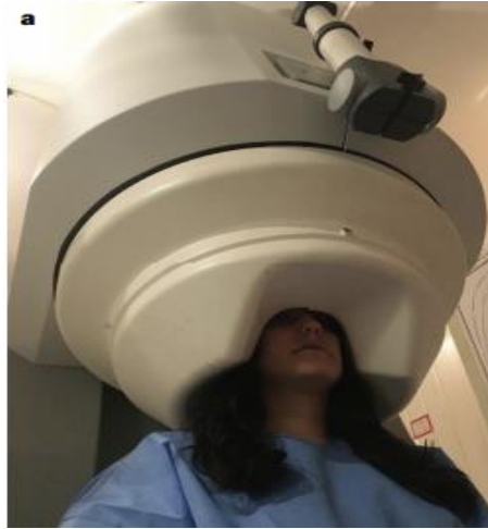
Figura 1.4. Equipamento de MEG baseado em SQUIDs. Adaptado de [15].
