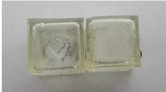
Figura 4.14. Influência da utilização de suportes na qualidade superficial da face inferior da célula: sem suportes (esquerda); com suportes (direita).
