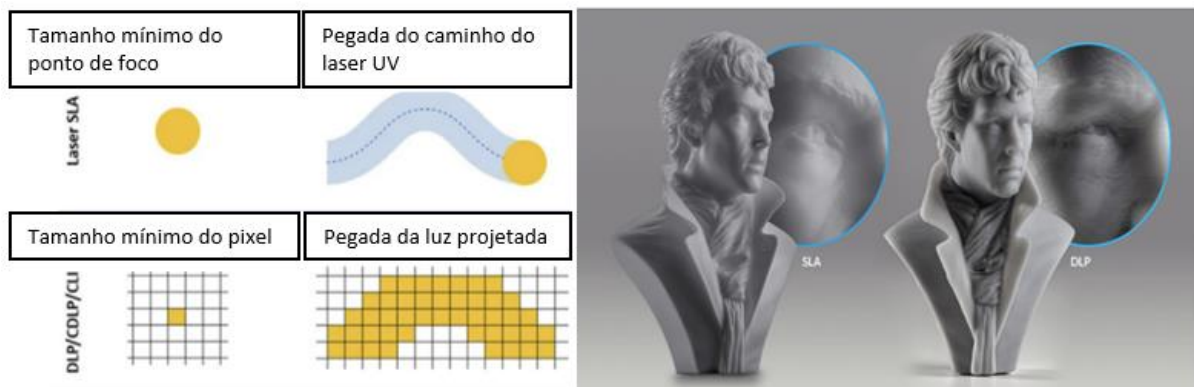
Figura 2.13. Diferenças da qualidade de impressão entre SLA e DLP. Adaptado de [72].
