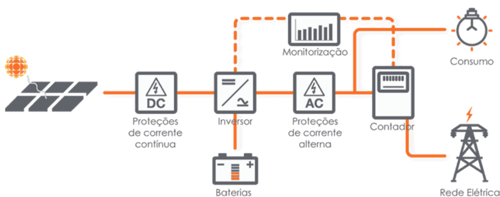
Figura 44 - Esquema representativo de uma UPAC. [Adaptado (Anzalchi & Sarwat, 2017)]
