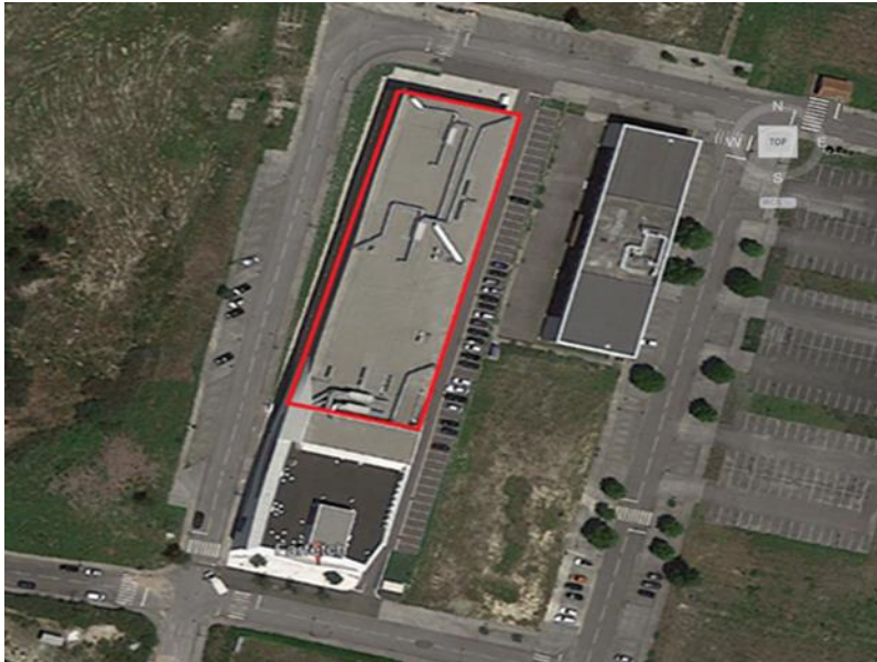
Figura 49 - Cobertura disponível para a instalação fotovoltaica.
