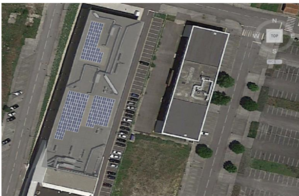
Figura 57 - Configuração final do sistema fotovoltaico do local em estudo com azimutes de -75^\circ e 105^\circ e inclinação de 13^\circ .
