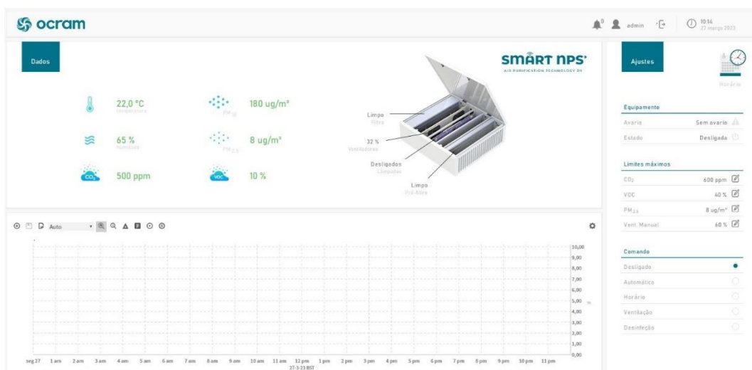
Figura 80 – Aspeto da página web para controlo e monitorização do equipamento Smart_NPS
