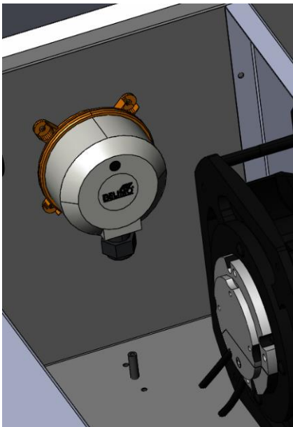
Figura 50 - Modelação 3D de um pressostato
