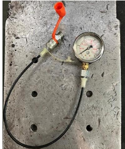
Figura 36 - Ilustração de um manómetro [AMOB S.A]
