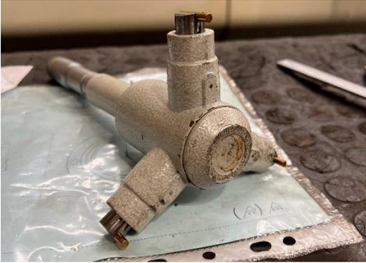
Figura 27 - Micrômetro interno de três contatos [AMOB S.A]
