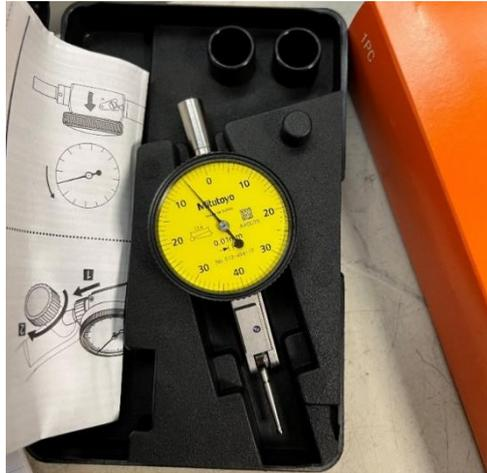
Figura 34 - Ilustração do comparador interno [AMOB S.A]
