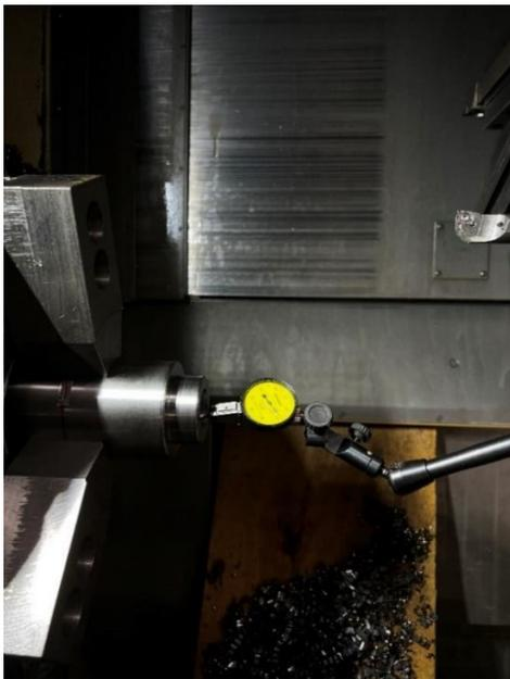
Figura 46 - Demonstração da medição de um comparador interno
