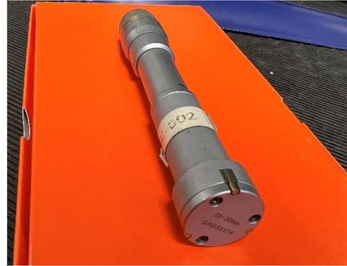
Figura 28 - Micrômetro interno de três contatos com pontas intercambiáveis [AMOB S.A]
